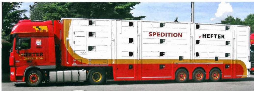
Für den Transportversuch wurden Fahrzeuge der Spedition Hefter genutzt, die sich auf den Transport wertvoller Zuchttiere spezialisiert hat. Selbststränken und Lüftungsventilatoren sind Standard.
