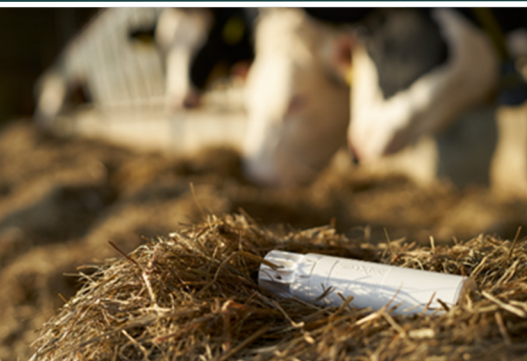
Pansenboli der Fa. smaXtec – die Firma ist ebenfalls Forschungspartner im Projekt D4Dairy - dienen dazu, wertvolle Informationen wie PH-Wert, Temperatur über die Vorgänge direkt im Pansen zu erfassen.
