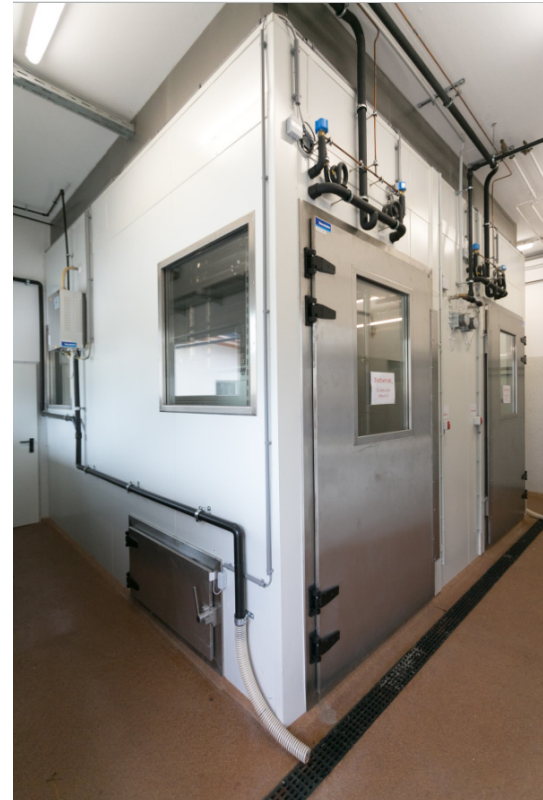
An der HBLFA Raumberg-Gumpenstein werden zwei Respirationskammern betrieben, mit welchen gasförmige Ausscheidungen (Methan und Kohlendioxid) von Kühen gemessen werden können. Da die Methanemissionen von Wiederkäuern im Zusammenhang mit dem Klimawandel stark diskutiert werden, forschen die MitarbeiterInnen der HBLFA Raumberg-Gumpenstein daran, wie diese reduziert werden können. Bisherige Erfahrungen aus internationalen Studien zeigen, dass Methanemissionen sowohl durch die Fütterung als auch durch züchterische Maßnahmen beeinflusst werden können. Daher wird derzeit untersucht, welchen Einfluss der Genotyp von Kühen und die Fütterungsstrategie (unterschiedlich hohe Kraftfutteranteile) auf die Methanemissionen von Milchkühen hat.
